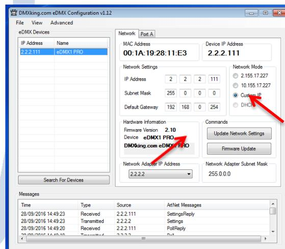
No caso de realizar uma atualização de Firmware, a seleção de "Firmware Update" irá solicitar um arquivo de firmware apropriado que deverá ser obtido previamente para realizar o seu upload após a confirmação. A unidade possui um Boot-loader que permite após a inicialização realizar a atualização do firmware.
