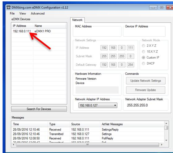
O eDMX é fornecido com a configuração padrão de IP Address 192.168.0.111, modifique-o para um IP Address compatível com ArtNet (2.x.x.x) e Mascara de Sub-Rede 255.0.0.0; No exemplo da foto abaixo IP Address 2.2.2.2 Lembre-se que os consoles da MA Lighting emitem Art-net com IP's de Classe A da faixa de 2.x.y.z. e 10.x.y.z.
